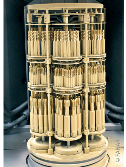
FANAR beschichtet nun mit einer CemeCon-Anlage im eigenen Haus.
