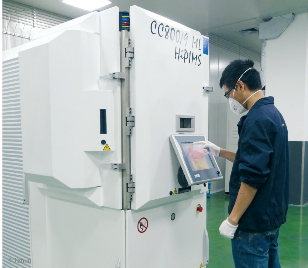
Die CC800®/9 ML HiPIMS ist eine Kombination aus HiPIMS- und DC-Technologie.
