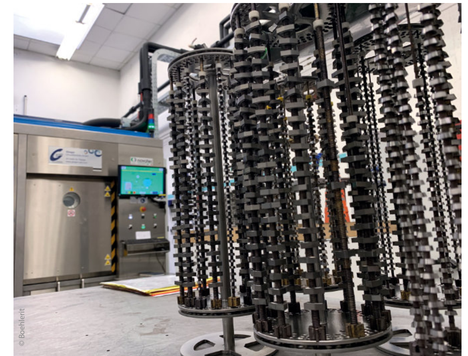
Breite Innovations- und Investitionsoffensive bei Boehlerit: Die neue Reinigungsanlage bereitet die Wendeplatten optimal auf die Beschichtung vor
