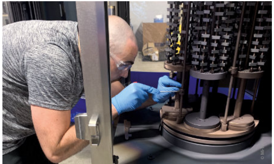
Mi-Tech konnte bereits kurz nach der Installation der HiPIMS-Anlage die erste Charge beschichten
