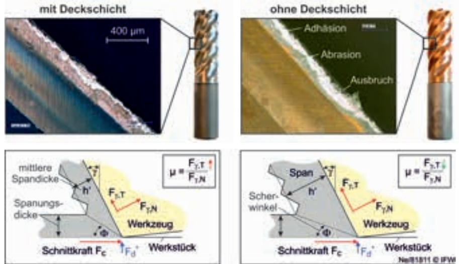
Mit der Deckschicht reduzierten sich die Adhäsionen und somit die Ausbrüche an der Schneide. Das kann auf das verbesserte Reibungsverhalten an der Spanfläche zurückgeführt werden. (Foto: IFW)
