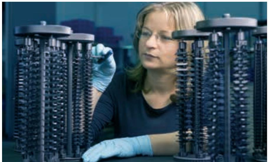
In der Produktionslinie für Wendeschneidplatten werden die Werkzeuge optimal beschichtet – dank verschiedener Kombinationsmöglichkeiten aus Vor- und Nachbehandlung, Schichtwerkstoff und Toleranzen etc.
